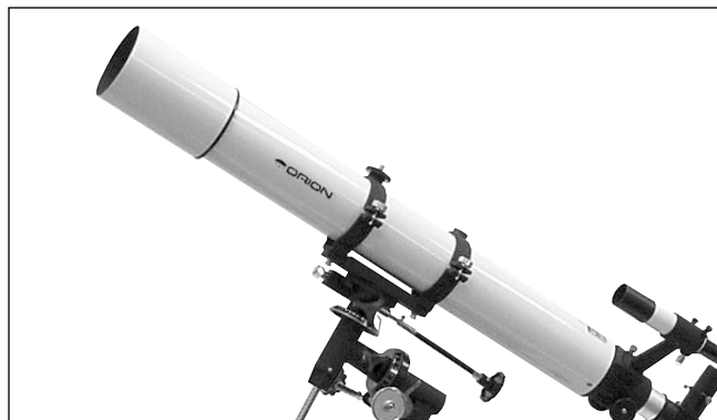
Abbildung 3a. Ausbalancieren des Teleskops auf der RA-Achse. Das Gegengewicht muss entlang der Stange verschoben werden.
