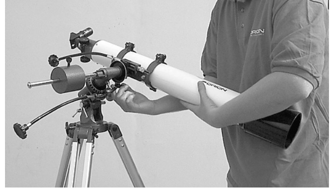
Abbildung 3c. Vorbereiten des Teleskops für das Ausbalancieren auf der Dek-Achse. Zuerst muss die Dek-Arretierschraube gelockert werden.
