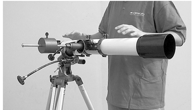
Abbildung 3e. Das Teleskop ist nun auf der Dek-Achse ausbalanciert, d. h. es bleibt auch dann in der Waagerechten, wenn es nicht mit der Hand gestützt wird.
