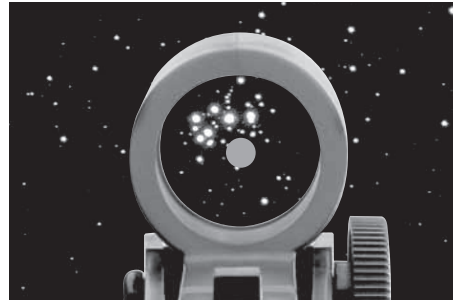
Figura 7. La EZ Finder II superpone un pequeño punto rojo en el cielo, mostrando exactamente donde está apuntando el telescopio.
