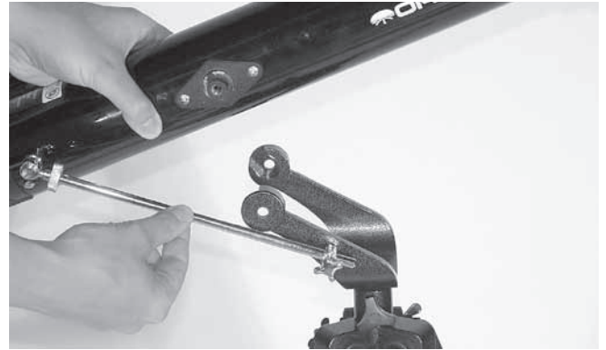
Figura 4. Instalación del tubo óptico en la montura altacimutal de horquilla.
