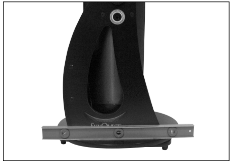
Abbildung 8. Legen Sie eine Wasserwaage auf die Basis, wie in der Abbildung dargestellt. Die Basis muss bei einer Drehung um 180° auf der Azimut-Achse kontinuierlich in der Waagerechten bleiben. Sobald der vertikale Anschlag justiert ist, braucht die Basis nicht mehr waagrecht zu stehen, um ordnungsgemäß zu funktionieren.
