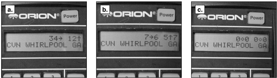
Abbildung 11. Diese Bildfolge zeigt Ihnen, wie die Richtungspfeile des Steuergeräts Ihnen dabei helfen, ein Objekt zu finden. (a.) Wenn Sie noch weit von der korrekten Ausrichtung auf ein Objekt entfernt sind, wird eine Zahl (zwischen 10 und 179) links von den Richtungspfeilen angezeigt. (b.) Wenn Sie sich der korrekten Ausrichtung auf ein Objekt nähern, wird jeweils eine Zahl unmittelbar links (zwischen 0 und 9) und unmittelbar rechts (zwischen 0 und 9) neben dem jeweiligen Richtungspfeil angezeigt. Die Zahl auf der linken Seite steht für ganze, die Zahl auf der rechten Seite für Zehntelschritte. Dies hilft Ihnen bei der allmählichen Annäherung der Ausrichtung des Optikrohrs auf ein Objekt. (c.) Wenn statt der Richtungspfeile „0.0 0.0“ angezeigt wird, befindet sich das gewünschte Objekt im Sichtfeld des Teleskops (bei Verwendung eines Okulars mit einer Brennweite von 25 mm oder länger).
