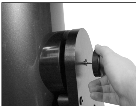
Figura 7. El botón de retención pasa a través del eje de la unidad del codificador de altura antes de enroscarse en el rodamiento lateral del tubo del telescopio.
