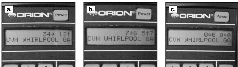
Figura 11. Esta secuencia de imágenes muestra el aspecto de las flechas de orientación al tratar de localizar un objeto. (a.) Cuando se está lejos del objeto, aparece un número (de 10 a 179) a la izquierda de las flechas de orientación. (b.) Cuando se está cerca del objeto, cada flecha de orientación muestra un número a su izquierda inmediata (de 0 a 9) y derecha inmediata (de 0 a 9); el número de la izquierda son incrementos de números enteros y el de la derecha son incrementos de décimas. Esto ayuda a hacer pequeños movimientos con el telescopio para determinar la ubicación del objeto. (c.) Cuando las flechas de orientación muestran "0.0 0.0", el objeto está dentro del campo de visión del telescopio (con un ocular de 25 mm de distancia focal como mínimo).
