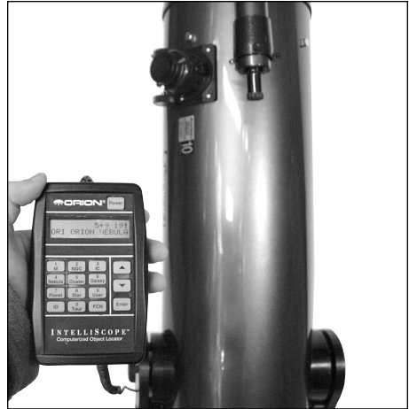
Figura 10. Si se sitúa a la izquierda del telescopio y mira hacia donde apunta el tubo, las flechas de orientación corresponden exactamente a la dirección a la que debería mover el telescopio para encontrar el objeto seleccionado.
