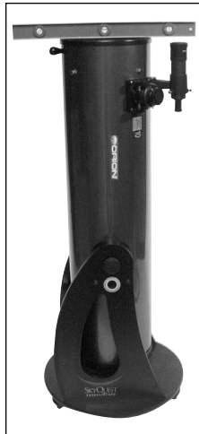
Figura 9. Una vez que la base esté nivelada, apunte el tubo hacia arriba, hasta que la celda del espejo entre en contacto con el tope vertical. Luego, coloque el nivel de carpintero en la parte superior del tubo, como se muestra. Si el tope vertical está configurado correctamente, la parte superior del tubo también debe estar nivelada.
