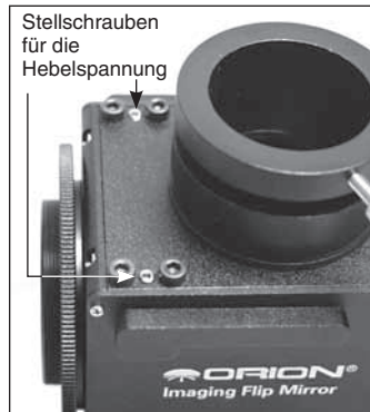
Abbildung 6. (Oben) Mit den beiden silbernen Inbusschrauben über dem Hebel wird die Hebelspannung eingestellt.
