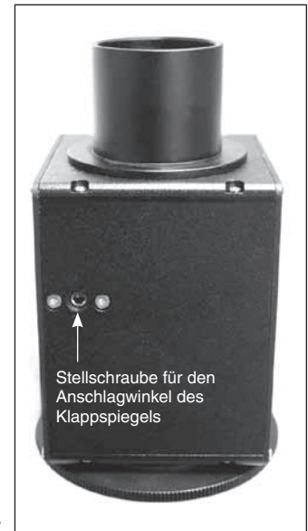
Abbildung 7. (Rechts) Mit der Inbusschraube an der Unterseite der Klappspiegeleinheit wird der Anschlagwinkel des Spiegels eingestellt.
