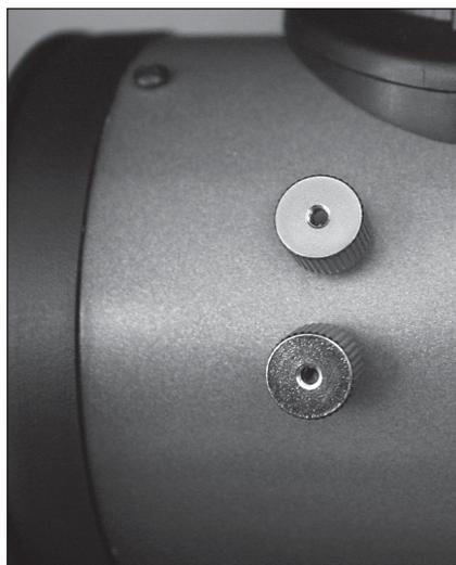
**Figure 3 :** Vis papillon pour l'installation du support du chercheur à point rouge
