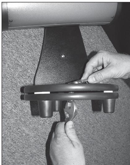
**Figure 6 :** Réglage de la tension azimut
