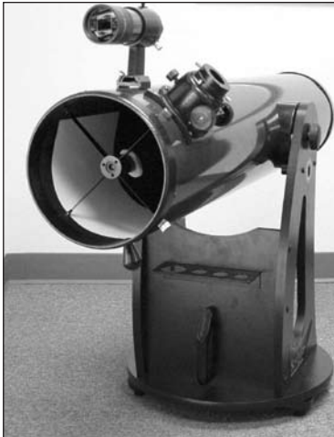
Figure 26. Tube optique SkyQuest correctement configuré pour la collimation. Remarquez le papier blanc placé en travers et l'angle du tube optique. Idéalement, le télescope doit être pointé sur un mur blanc. (modèle IntelliScope représenté)
