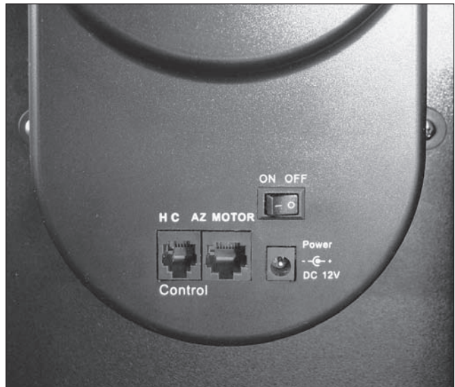
Figure 23. Le carter du moteur d'altitude dispose de l'interrupteur d'alimentation ON/OFF et de plusieurs ports de câbles.
