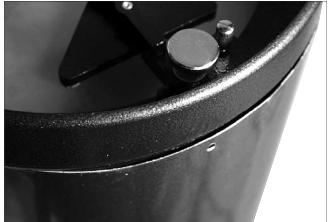
Figure 16. Localisez la zone du tube avec le renflement et évitez que la bague d'extrémité ne soit totalement en appui.
