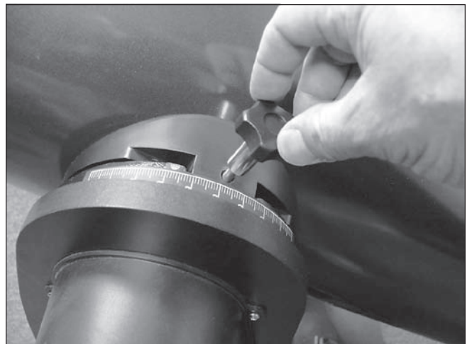
Figure 19. Fixez le tube sur la base à l'aide du bouton d'assemblage du tube.
