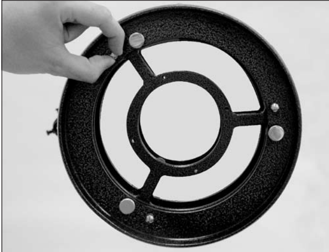
Figure 29. Les trois petites vis de serrage qui verrouillent le miroir principal en position doivent être desserrées avant de procéder à tout ajustement.
