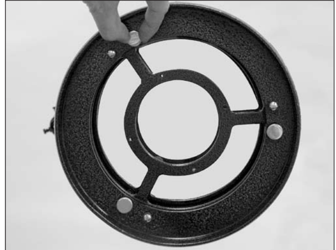
Figure 30. L'inclinaison du miroir principal est ajustée en tournant une ou plusieurs des trois vis de serrage plus grosses.
