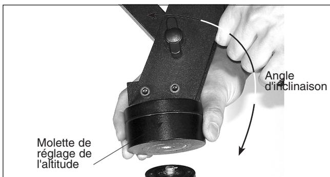
**Figure 4.** L'« angle d'inclinaison » des jumelles
