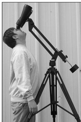
**Figure 6.** La monture des jumelles peut être utilisée pour observer des objets au zénith ou proche du zénith. Réglez le trépied pour pouvoir vous tenir debout en dessous des jumelles afin d'observer des objets situés haut dans le ciel.
