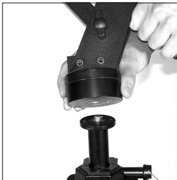
**Figure 2.** Alignez l'axe de fixation fileté du trépied avec le trou fileté sur la partie inférieure du disque pivot. Maintenez ensuite la monture des jumelles tout en tournant le disque pivot pour le visser sur l'axe.
