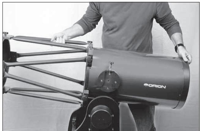
**Figura 26.** Para montar todo el ensamblaje del tubo sobre la base, agarre la parte trasera del tubo con una mano y un de los palos truss con la otra. Con el telescopio orientado horizontalmente, bájelo hacia la base, deslizando la ranura de cola de milano dentro del rodamiento izquierdo de altura del tubo sobre la parte de apareamiento del muñón metálico del panel izquierdo de la base.
