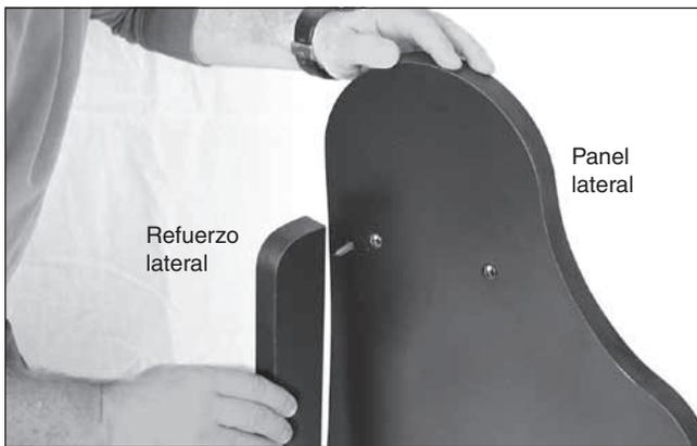
**Figura 7.** Sujete un refuerzo lateral al exterior de cada panel lateral utilizando tres tornillos de madera de montaje de la base y la llave hexagonal de 4mm. En el XX12g, el panel izquierdo es más corto que el refuerzo lateral derecho. En el XX14g, los refuerzos laterales tiene la misma longitud.
