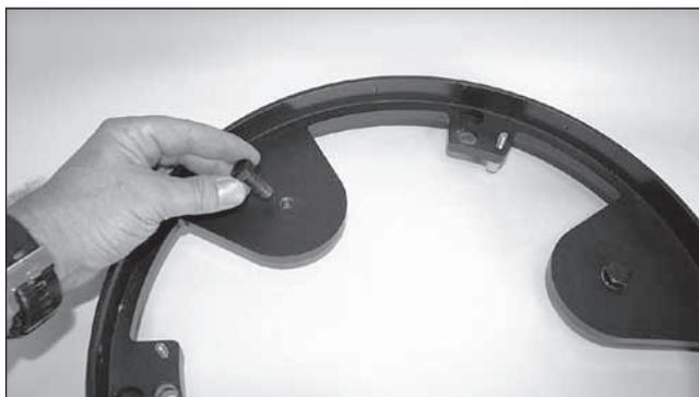
**Figura 14.** Enrosque los tres pernos de montaje de contrapeso de cabeza hexagonal (únicamente XX14g) en los agujeros de las placas de soporte de contrapeso, como aparece ilustrado. Apriete utilizando una llave inglesa de 16mm o graduable.
