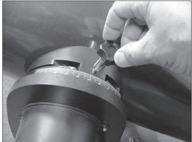
**Figura 25.** Fije el tubo a la base con el botón de montaje del tubo.
