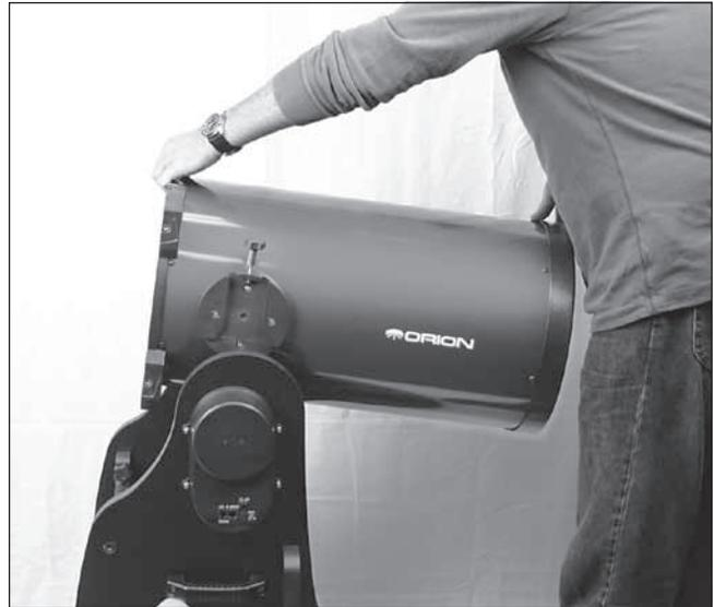
**Figura 23.** Agarre las dos extremidades de la sección inferior del tubo para levantarlo, y entonces bájelo en la base, deslizando la ranura de cola de milano dentro del cubo izquierdo de altura del tubo sobre la parte de apareamiento del muñón metálico del panel izquierdo de la base.
