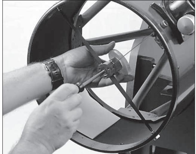
**Figura 33.** Para centrar el espejo secundario bajo el enfocador, sujete el soporte del espejo con una mano mientras ajusta el perno central con un destornillador Phillips.
