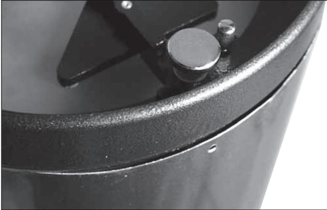
**Figura 16.** Localice la parte del tubo que sobresale e inhibe que el anillo de extremidad se asiente totalmente. Aplique presión al bulto para dejar el barrilete del espejo asentarse adecuadamente en el tubo. ¡Tenga cuidado de no pillarse los dedos!
