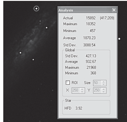
Imagen 10. La ventana Analysis muestra datos muy útiles sobre su imagen. Desplazar el ratón encima de una estrella le mostrará el valor HFD que indica el diámetro de la estrella, para un mejor enfoque.
