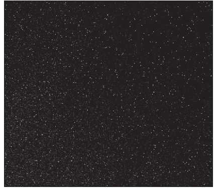
Imagen 14. Un cuadro oscuro contiene ruido térmico y de fondo, así como todo ruido de lectura. El mismo ruido aparece en sus imágenes “luminosas”. Cuadros o fotos oscuras aíslan el ruido para quitarse después de las imágenes “luminosas”.
