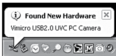
Abbildung 3. Wenn Sie die SSUEII-Kamera zum ersten Mal an einen Computer anschließen, wird die Benachrichtigung „Neue Hardware gefunden“ eingeblendet, und die Kameratreiber werden automatisch installiert.
