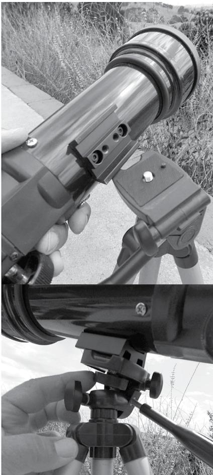
**Étape 4 :** Fixez le chercheur sur le tube optique.
