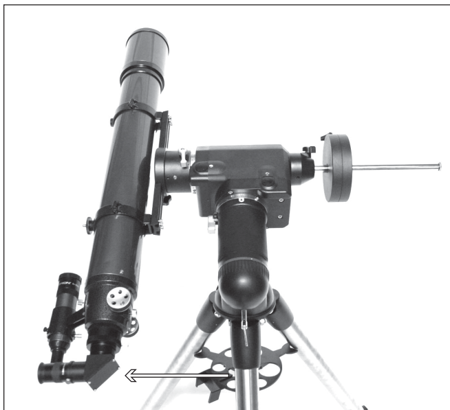
Abbildung 7. Bewegen Sie das Teleskop leicht in horizontaler Richtung, um die Richtung des Achsversatzes der optischen Achse zu bestimmen.
