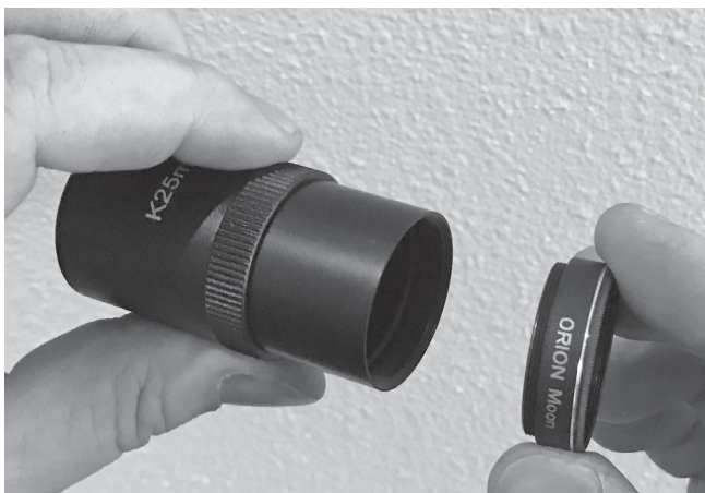
Abbildung 13. Die Steckhülsen der Kellner-Okulare sind mit Gewinde versehen, in die separat erhältliche 1,25" (32 mm) Orion-Filter passen. Ein Mondfilter ist nützlich, um Blendung zu reduzieren und so mehr Details auf der Mondoberfläche zu zeigen.
