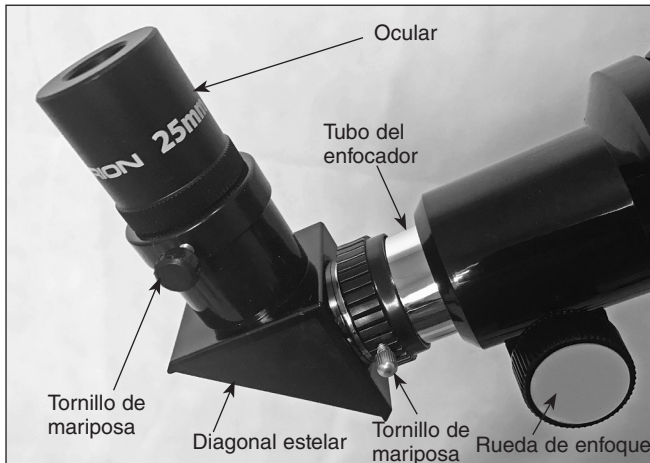
Figura 10. Sujete la diagonal estelar en el tubo del enfocador con el tornillo de mariposa del cuello del tubo y, a continuación, instale el ocular en la diagonal.
