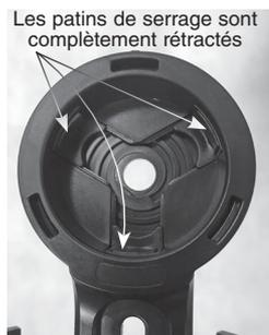
**Figure 4.** Tournez le boîtier de la tourelle jusqu'à ce que les patins de serrage soient grand ouverts (alignés sur le bord intérieur de la tourelle).
