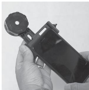
**Figura 2.** La staffa regolabile può essere aperta abbastanza da contenere anche telefoni cellulari di grandi dimensioni. Il telefono viene fissato saldamente in posizione grazie all'imbottitura in gomma e alle guide laterali inclinate verso l'interno.
