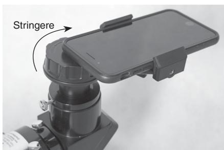
**Figura 5.** Posizionare la torretta sull'oculare dello strumento (a) e ruotare l'alloggiamento con serraggio a torsione della torretta fino ad afferrare saldamente l'oculare (b).
