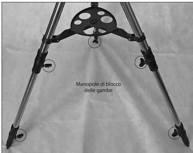
**Figura 9.** Regolare le gambe del treppiede alla lunghezza desiderata, quindi bloccarle ruotando le manopole di blocco delle gambe in senso orario.
